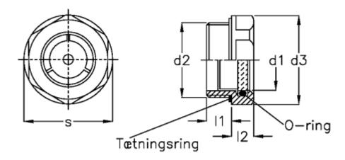
d1 = 14 d2 = M20x1,5 d3 = 26 l1 = 8.5 l2 = 7.5 Max pressure = -Max vacuum mbar = s = 23
